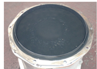
DPRが損傷した事例（排出ガス入口）
