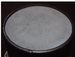
DPRが損傷した事例（排出ガス出口）
