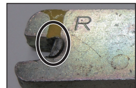
ストラットの摩耗例
