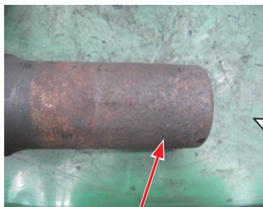
スプラインヨーク部摺動面の錆付き
