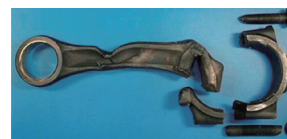
クランクメタルの焼き付き メタル焼き付きによるコンロッドの破損
