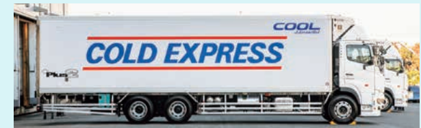
荷室の前後にスリム化を図った高性能断熱材を使用し、荷室内寸10m3cmを実現しました。
