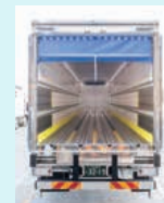
荷室の前後にスリム化を図った高性能断熱材を使用し、荷室内寸10m3cmを実現しました。
