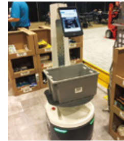
商品を集めながら移動する「ケース搬送型ロボット」（筆者撮影）
