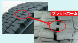
残り溝深さが「フラットホーム」に達している状態。 冬用タイヤとして使用できません。(画像:国土交通省)
