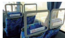
シート背裏取付型飛沫防止パネル(A型)。
