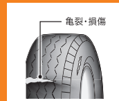
タイヤの亀裂・損傷
