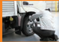
タイヤに亀裂や損傷がないか手で触って確認。
