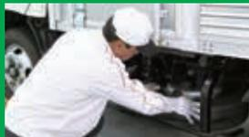
大型トラック・バスのスペアタイヤ、およびツールボックスの定期点検は義務です。
