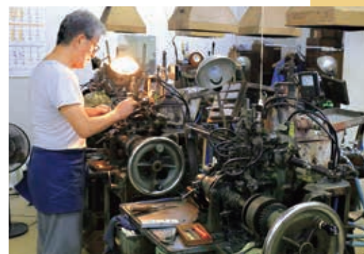
鋳造機を操る職人の大松初行さん。溶解した地金を母型に流し込み、ミリ単位の調整を行いながら活字を生み出していく。
