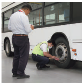
運行前点検競技では、指定時間内にタイヤの異常の有無を確認します。
