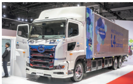
高速道路での自動運転レベル4相当の走行を想定し、カーボンニュートラルの実現に貢献する燃料電池大型トラック「日野プロフィア Z FCV(L4コンセプト 参考出展)」。
