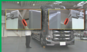
「車高灯」の点灯
