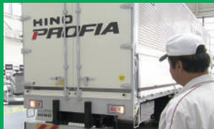
「バックランプ」の点灯と併せてバックブザー音も確認
