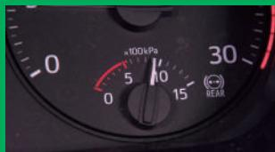
空気圧力計の上がり具合および、適性の範囲内に収まっているかを確認します。
