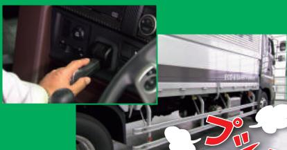
既定の空気圧の状態で、レバーを駐車位置まで引いた時、レバーが固定され空気の排出音が聞こえるかを確認します。
