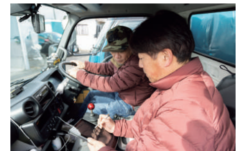
作業者はタブレットで計画ルートを見ながら収集作業が可能。新人作業者の指導も効果的に行えます。
