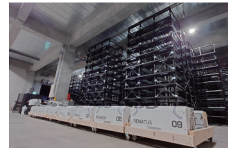
ロボット自動倉庫によるGTPソリューションが、少人数・高生産性の物流を実現。
