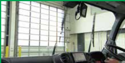
拭き取り状態と同時に、ワイパーのLow・Hiの作動状態も確認。
