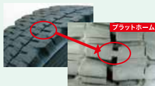
残り溝の深さが「プラットホーム」に達している状態。冬用タイヤとして使用できません。(画像:国土交通省 自動車局提供)
