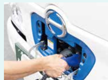
充電口はフロント部分に設置。またリチウムイオンバッテリーは、ミッドシップ・低重心を考慮しホイールベース間にレイアウトしています。
