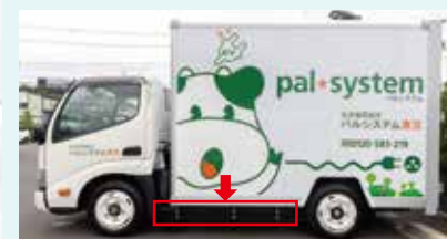
充電口はフロント部分に設置。またリチウムイオンバッテリーは、ミッドシップ・低重心を考慮しホイールベース間にレイアウトしています。
