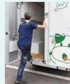
超低床により、ワンステップで荷室への乗降が可能。安全性と荷役性の向上を両立しています(床面上高:480mm)。
