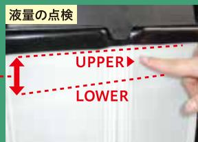
\*補給後は、必ず充電(走行)をしてください。寒い時期はバッテリー液が凍結し、バッテリーケースが破損する恐れがあります。
