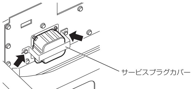
2. 絶縁手袋を着用し、HV バッテリーからサービスプラグを取りはずす (下図参照)。
