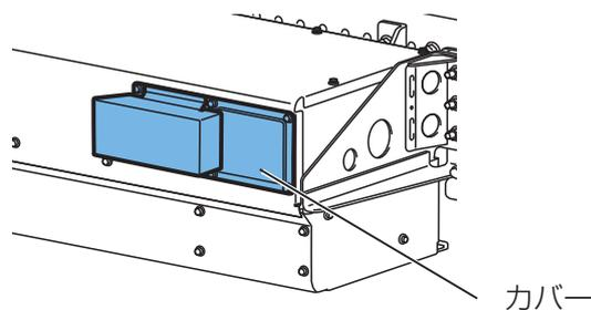
2. 絶縁手袋を着用し、HVバッテリーからサービスプラグを取りはずす (下図参照)。
