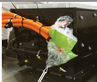
高電圧端子取り外し後に端子部を養生して ください。 端子部に損傷等、懸念事項ある場合、更に 袋をかぶせてください。
