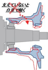
②ベアリングとアウターレース間に隙間があることを確認する
