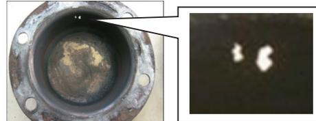
ベアリングの古いグリースを除去したうえで、異常が無いか確認してください。コロの端面の傷・錆は見落としやすいので特に注意して入念に点検してください。また、金属粉がある場合は、アウターレース及びベアリングを交換してください。
