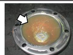
ハブキャップ内に充填するように充填し、写真のように円錐状に整える
