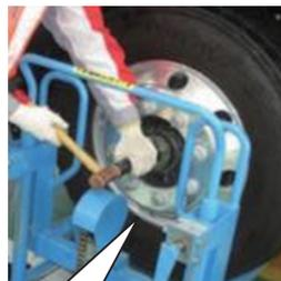
打ち込み用の治具の使用を推奨します
