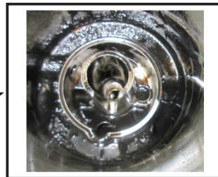
オイルフィルタケース内に スラッジが堆積した状態
