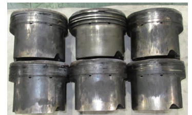
堆積したスラッジが原因で ピストンが焼き付く可能性あり
