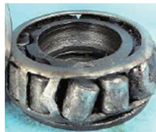
潤滑不良により破損
