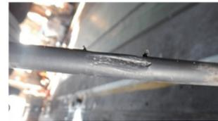
ケーブル外装の損傷部から水・砂塵が侵入し、冬場等にケーブルワイヤが凍結・固着
