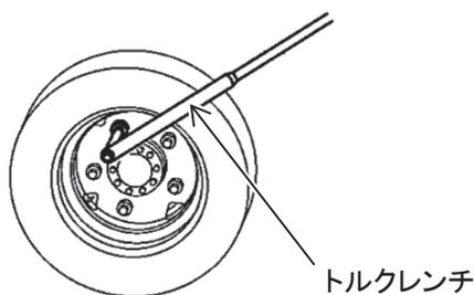
ボルト・ナットの破損防止のために、規定トルクで締め付ける必要があります
