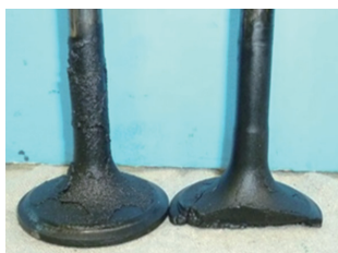
エンジンバルブが損傷した事例
