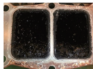
EGRクーラに化合物が堆積した事例
