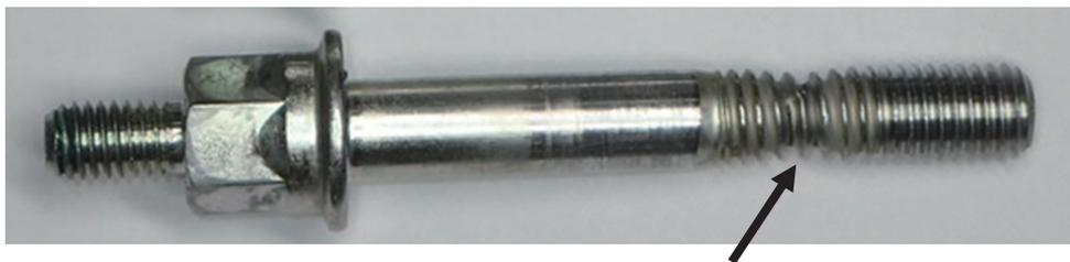
写真のようにボルトのネジ部が伸びた状態にも関わらずそのまま使用しますと、ボルトの緩みや破断に繋がる恐れがあります
