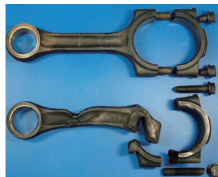
メタルが焼き付き 破損したコンロッド
