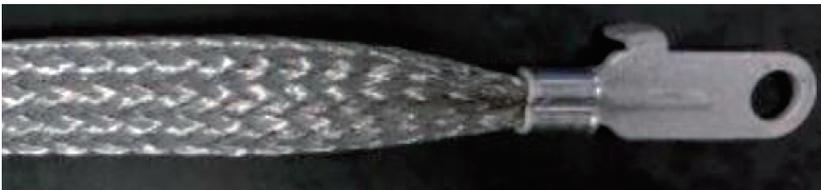
腐食・断線すると、電流はエンジンアース線流れず、パワーステアリングホースに流れ込み、ホースが発熱・焼損する場合があります。
