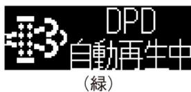
DPDは排気ガス中のPM（粒子状物質）を浄化するものです。DPDフィルターにPMを捕集し、一定量堆積すると自動的にフィルターを再生（PMを燃焼）させます。自動再生中は「DPD自動再生中」表示（緑）が点灯します。自動再生中はそのまま走行できます。DPDの故障を防ぐため、必ず次の点をお守りください。
