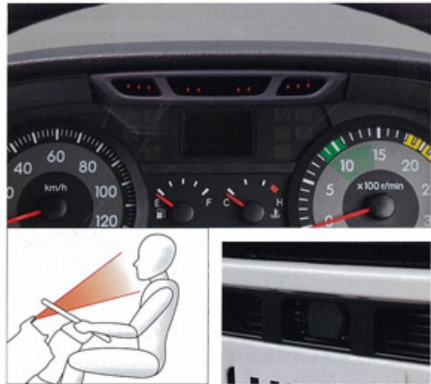
ドライバーモニターカメラと測定範囲
