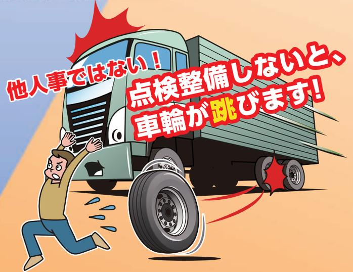
車輪が脱落するまでには必ず予兆があります。日頃の点検・整備で車輪脱落事故を防止。ご自身による車輪まわりの点検をお願いします。
