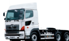
日野プロフィア トラクター 後2軸・6×4駆動 重量物用
