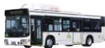
「ブルーリボンシティ CNGノンステップバス」 「ブルーリボンシティCNGノンステップバス」は、ハイレベルな低公害技術の採用と交通バリアフリー法に適合、さらにノンステップバス標準化仕様に対応しています。
