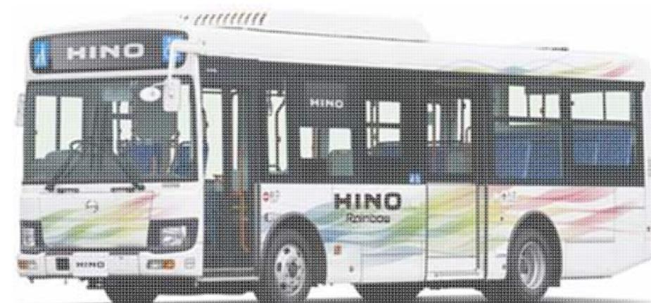
AMTの採用と新開発のボデーによる軽量化により燃費を向上させた中型路線バス「日野レインボー」(16年5月6日より発売)
