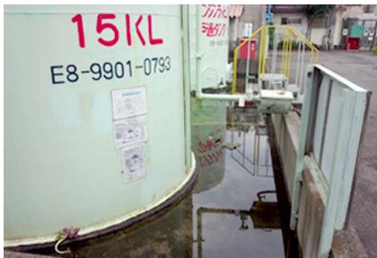
防液堤の水張り試験の様子
