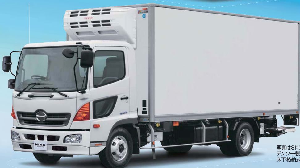
写真はSKG-FC9JJAA、中温冷凍車 菱重製冷凍機、 スイングアーム式テールゲートリフター装着車
