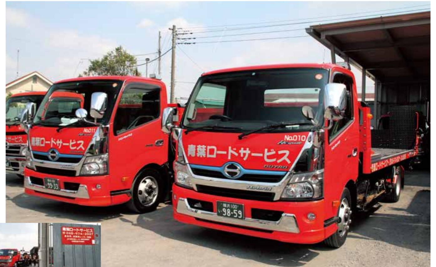
注目度抜群の日野デュトロハイブリッドは、ワイド幅キャブのハイグレード3.5トン積み。
