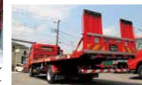
フラトップと呼ばれる車両積載車の後部。荷台は連動PTOにより、リモコン操作できる。
