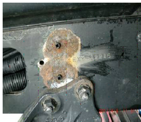
車台番号打刻周辺部のクリップ穴からの錆進行
