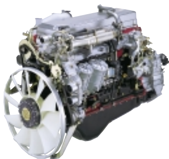
E13C 直列6気筒エンジン コモンレール式燃料噴射システム コンバインドEGR採用 可変ノズルターボ搭載 総排気量：12.913L 302kW（410PS）
