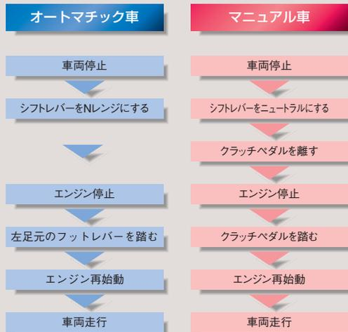
※アイドリング燃費の目安：1時間のアイドリングでエンジン排気量の約1/10の軽油が消費されます。
