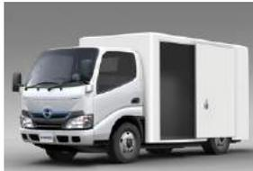
パワートレーンの小型化が可能なEVの特徴を生かし、FFにすることで荷台の低床化を実現。
