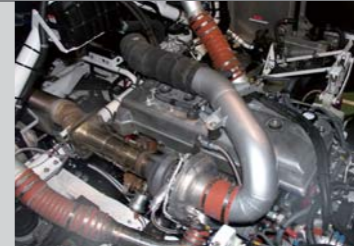
1号車に搭載された新開発のA09C-TI型エンジン。開発途上での先行投入となったが従来のJ08C-TI型に対して大幅なパワーアップをもたらし、好感触を得た
