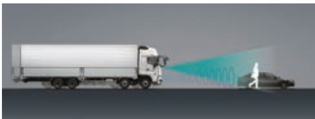
衝突被害軽減ブレーキ「PCS」 ミリ波レーダーと画像センサーで停止車両や歩行者も検知
